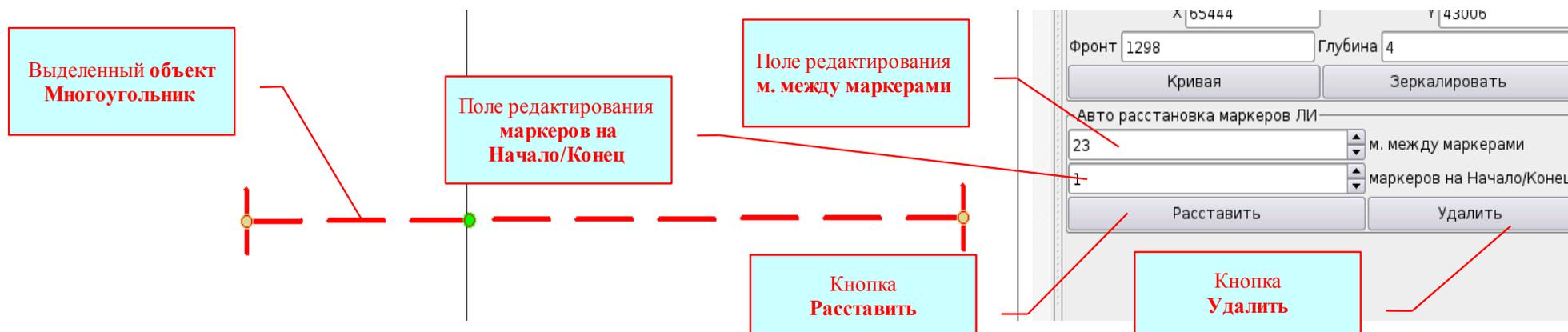
Рисунок II.50 Автоматическая расстановка маркеров лазерной имитации.
